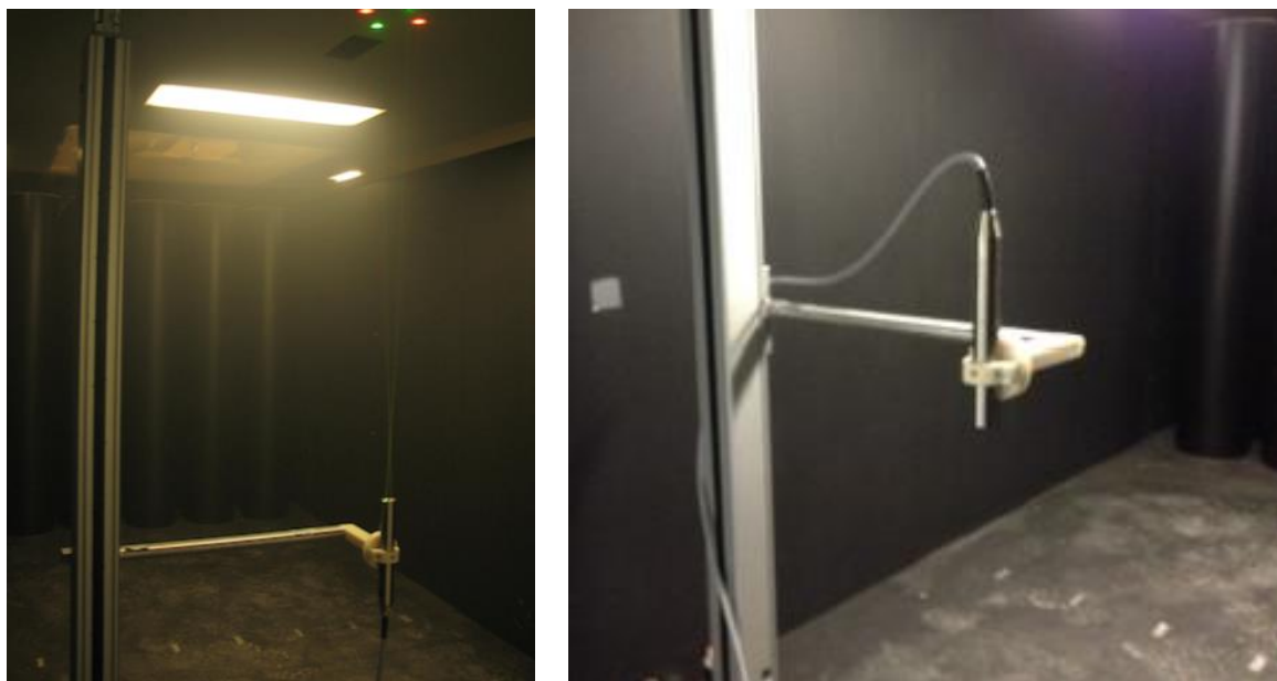
Figur 11 Montage av mätprobe och traverseringsanordning vid LDA-mätningar [2].
