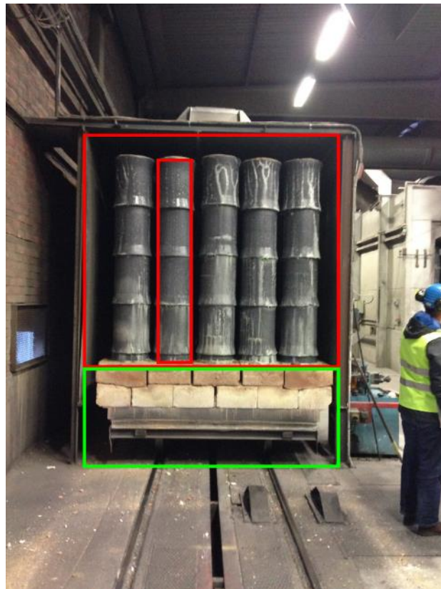
Figur 25 Bild som visar inlopp till svaltunneln, vilken har modifierats för fungera som prototypanläggning.
