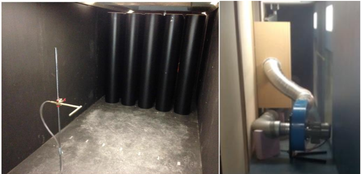
Figur 8 Paket med cylindrar (5×5) monterade i vindtunnel (vänster). Fläkt och tillhörande trycklåda för kylfluftsinsblås (höger) [2].
