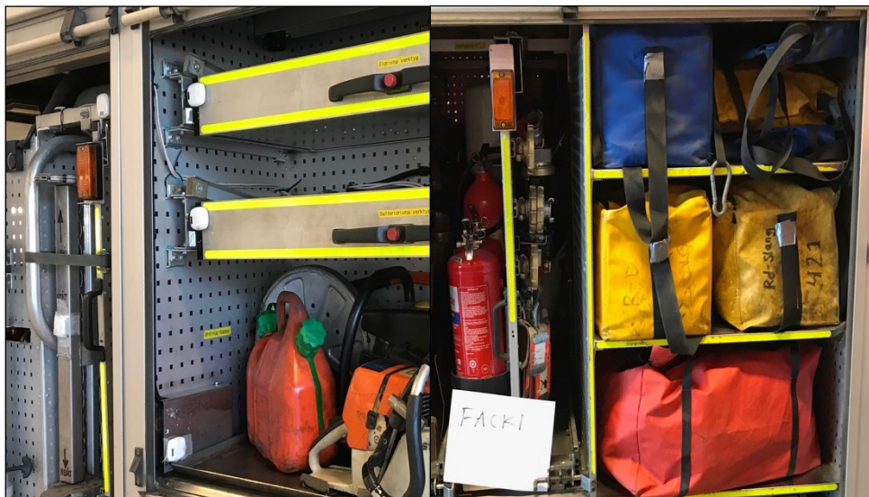
Figur 3: Vänster: Sensorer monterade på utdragshyllor och på skåpsdörr. Höger: Sensorer monterade på ett antal säckar, bland annat, med Rd-slang.
