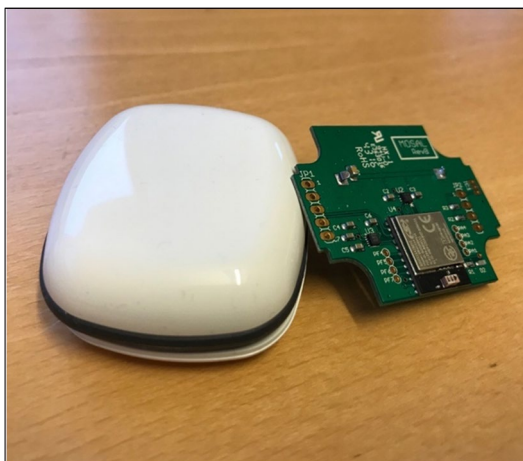
Figur 1: Sensor som användes för att märka upp verktyg och objekt i fyra räddningsfordon.
