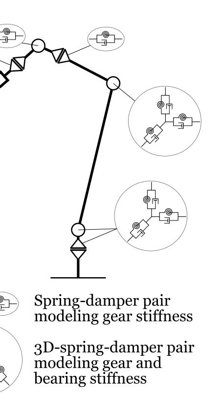
A lumped parameter robot model.
