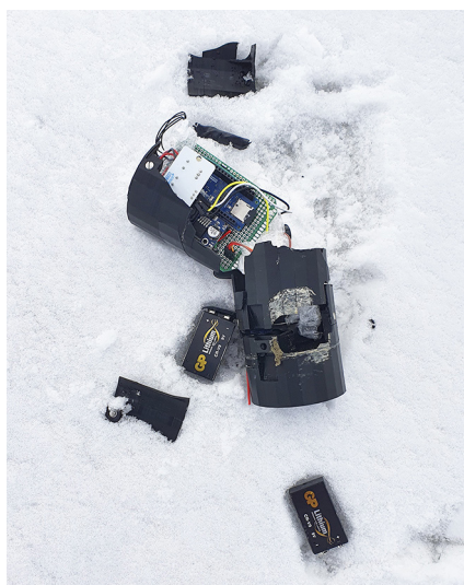
Resultatet av ett fall utan fallskärm i Vasa. På natten byggdes en ny. Foto: Johan Thun.
