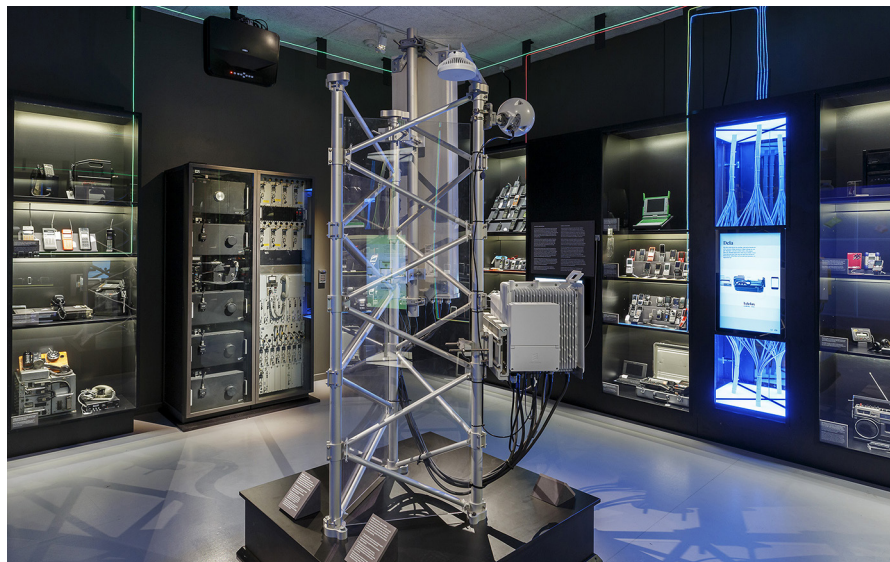
Basstation, av femte generationen i Ericssons utförande. Fungerar som anslutningspunkt för mobiltelefoner och annan utrustning som kommunicerar datatrafik. Foto: A. Gerdén, Tekniska museet
