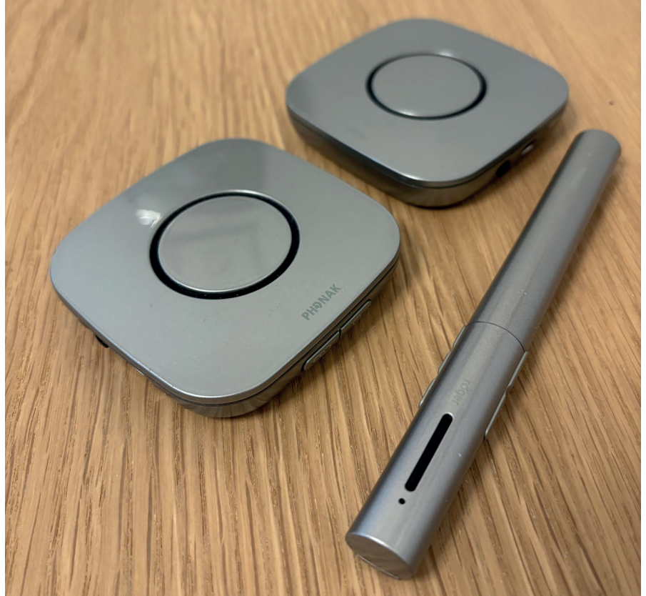
Rogersystemets mikrofoner strömmar ljudet direkt till hörapparaten. Mikrofonsystemet består av en riktningssärlig föreläsarmikrofon, rundupptagande bordsmikrofoner som kan placeras ut på konferensbordet och en mottagare som oftast programmeras in i hörapparaten. Foto: Anna Gryszkiewicz.
