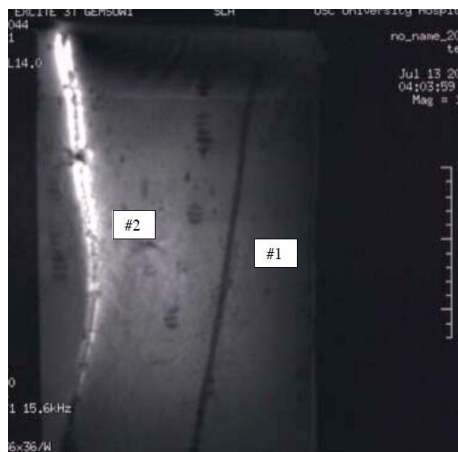
Fig. 2 Foley kateter utan (#1) respektive med (#2) temperatursensor. Gradienteko-sekvens vid 3 T [1]. Notera de relativt stora artefakterna.
